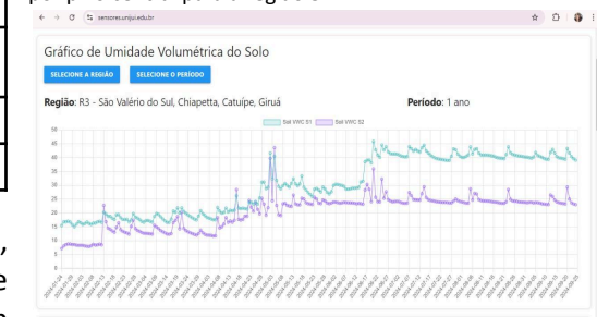
Figura 1: Vista da plataforma da rede de sensores para monitoramento da umidade do solo em área com irrigação por pivô central para a região 3.
